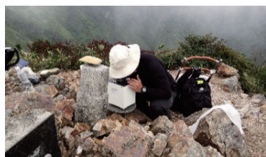
図1 重力観測の様子 場所を変えながら重力計でその地点での重力を測ります。
