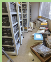
試料コンテナを乗せたまま水平に1m弱移動した試料ラック。ももとの位置は床面にある「J」の場所
